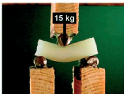
Abbildung 1. Durch Kreuzvernetzung mit einem Polymer verstärktes SiO 2 -Aerogel. [11]
